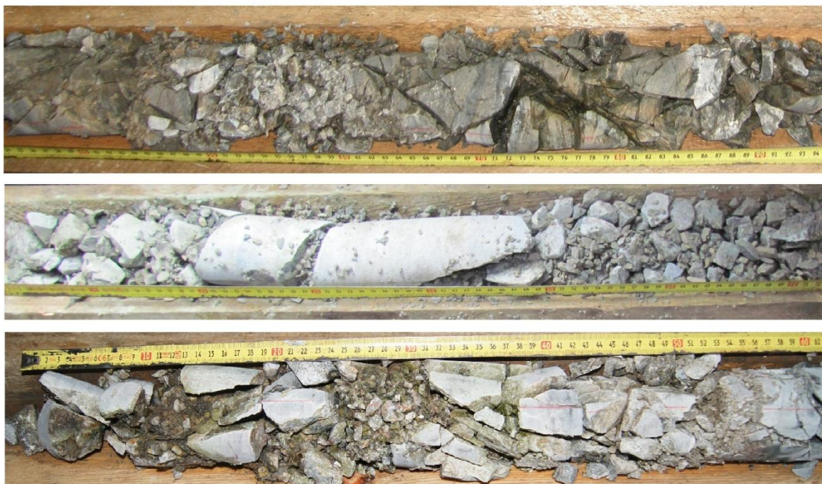
Рисунок 3.6 – Пример разрушения керна в зоне дробления
