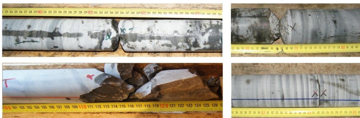
Рисунок 3.3 – Пример трещин механического происхождения
